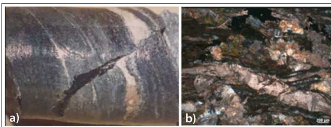
7. ábra | a) Amfibolit, elvált repedés mentén eltolódott leukosávval (Sz-173). b) Átkristályosodott amfibolit szövete, az amfiból szinte teljesen karbonáttá, epidottá alakult (+N, 200 millimikron, Sz-173) Figure 7 | a) Amphibolite with displaced leuco band along a separated crack (Sz-173). b) Texture of the recrystallised amphibolite, the amphibole has almost completely transformed into carbonate and epidote (+N, 200 millimikron, Sz-173)
